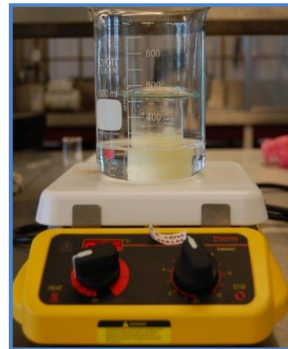
e. Agitación e incorporación en la Parrilla magnética
