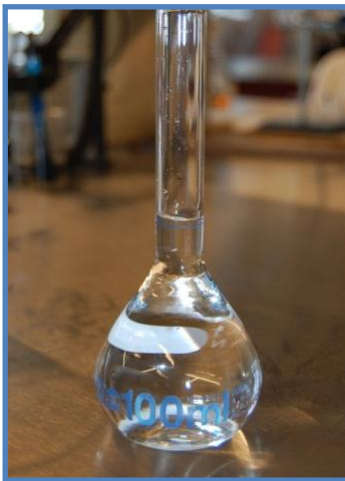
d. Matraz aforado para disolver \text{AgNO}_3 y \text{NaBH}_4
