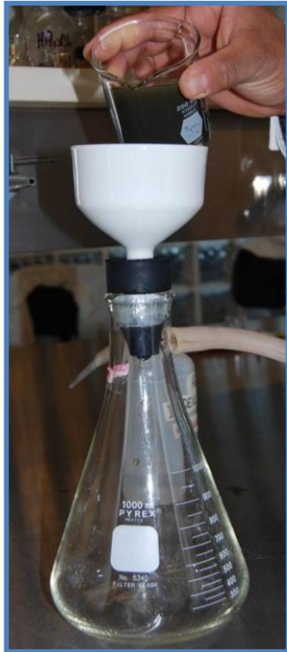
h. Filtrado al vacío en matraz Kitazato para separar nanopartículas de plata
