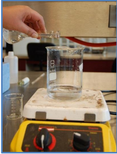
f. Incorporación del polvo precursor y el reductor
