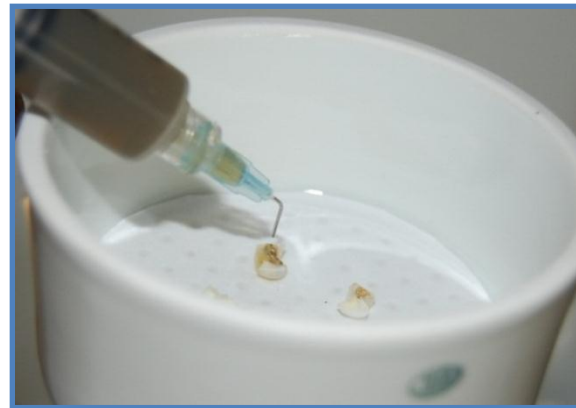
r. Dientes irrigados con Np-Ag, para observar al MEB
